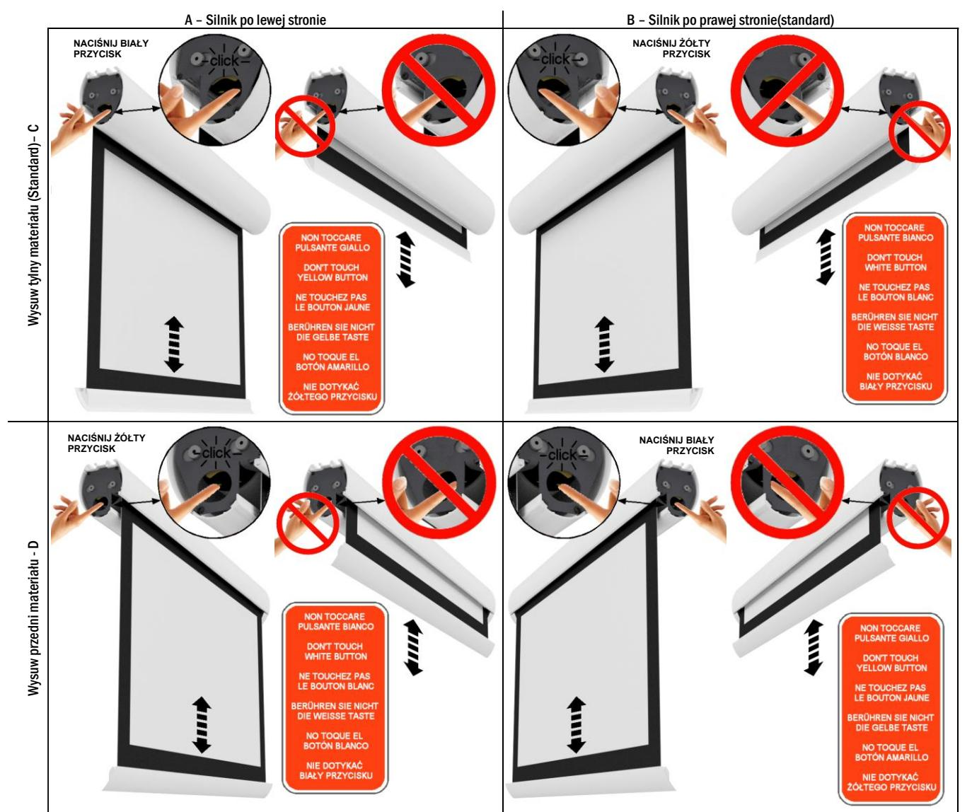
**PROGRAMOWANIE MOTOR SOMFY RTS 230V 50Hz/120V 60Hz (procedura, która została wykonana w fabryce, NIE może być wykonywana przez nieupoważnione osoby)**
