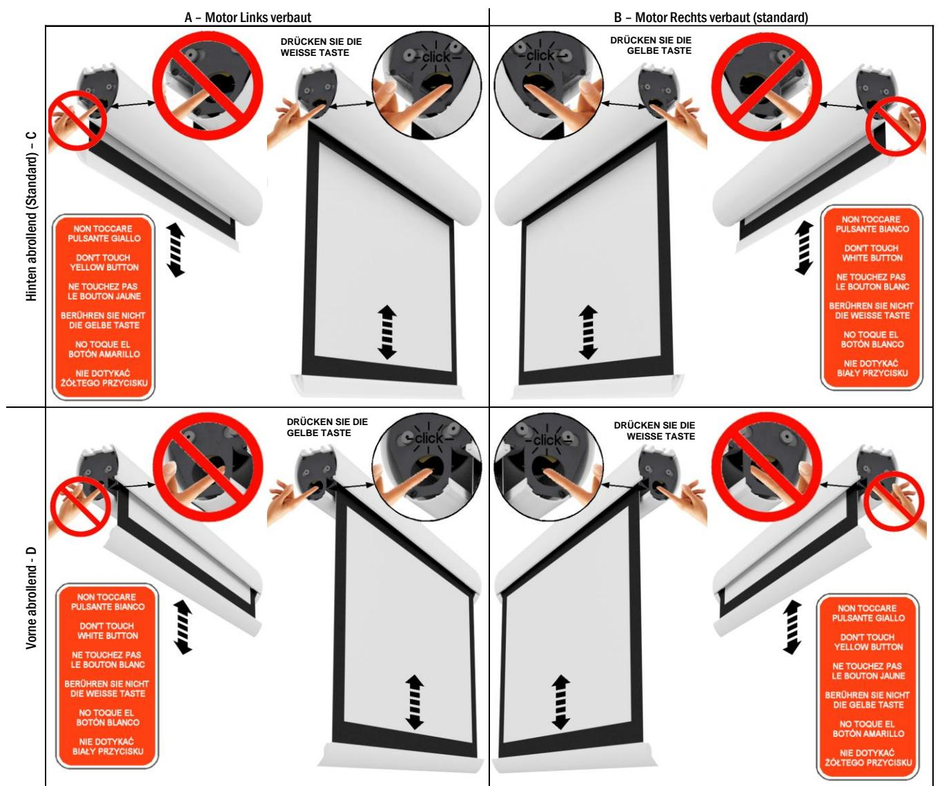
**PROGRAMMIERUNG DER MOTOR SOMFY RTS 230V 50Hz / 120V 60Hz (Dieser Vorgang wurde bereits im Werk vorgenommen und darf NICHT von unbefugtem Personal durchgeführt werden)**
