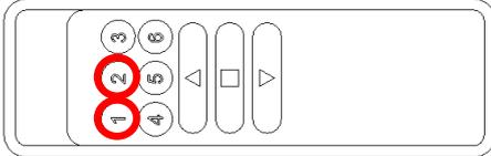
Przed rozpoczęciem programowania wybrać silnik, który chcesz zaprogramować za pomocą przycisku, 1 - silnika powierzchni projekcyjnej, 2 - silnika maskownic.
