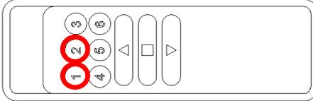
Bevor Sie beginnen, um den Motor zu wählen, die Programmierung, die Sie mit den Zifferntasten programmieren möchten, 1 - Projektionswand Motor, 2 - Mask Motor.
