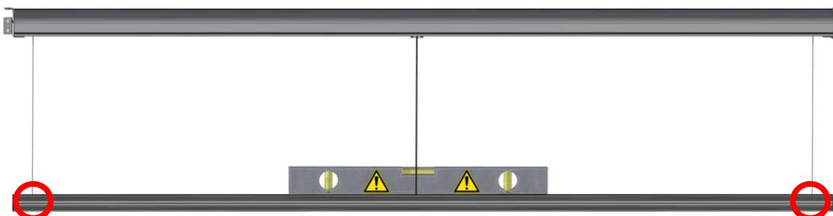
Instalacja ekranu możliwa tylko na dolnej płaszczyźnie profilu
