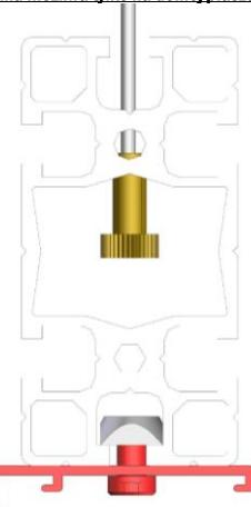
Zainstalować uchwyty ekranu wykorzystując nakrętki M6 już zainstalowane w dolnej części profilu. Następnie zainstalować ekran na uchwytach.
