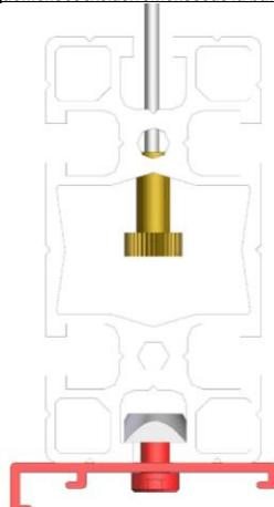
Fixez le support de l'écran sur l'écrou M6 déjà inséré dans la barre. Par la suite l'ancrage de l'écran pour les supports.
