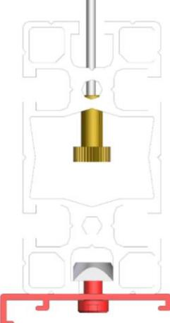
Befestigen Sie die Halterung des Bildschirms an der Mutter M6 bereits in der Bar eingesetzt. Anschließend verankern den Bildschirm, um den Bügeln.
