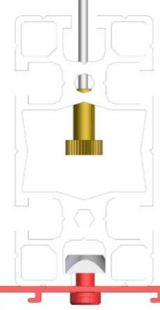
Fije el soporte de la pantalla en la tuerca M6 ya insertado en el bar. Posteriormente el anclaje de la pantalla a los soportes.
